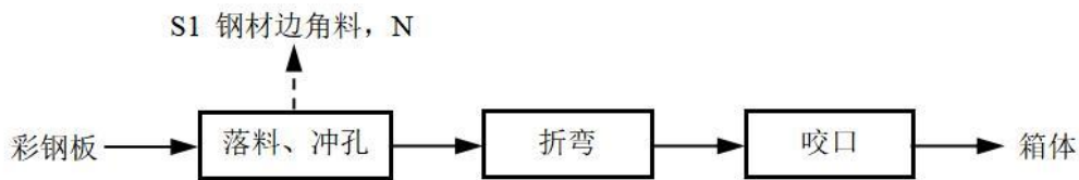
图 2.4-3 洗衣机箱体生产工艺流程图
